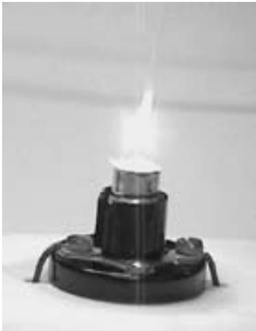
D'un cou de marteau sec, on brise l'ampoule de la lampe que l'on remonte sur son support.
