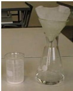
Le lait de chaux décante rapidement séparant la chaux éteinte d'un liquide transparent et incolore qui semble être de l'eau
