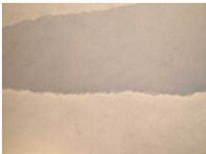
Le papier filtre observé à la binoculaire apparaît comme un agrégat de fibre de cellulose entrecroisées, plus ou moins serrées suivant la nature du papier filtre
