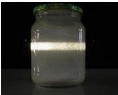
Sur le faisceau d'un projecteur un diaphragme détermine un faisceau de lumière dont on observe la trace.
